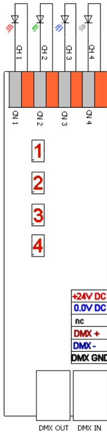
**Hinweis:** Die vier Feld-Effekt-Transistoren müssen gekühlt werden. Beachten Sie bitte die gegebenenfalls notwendige Isolierung der FET-Gehäuse, wenn FETS mit Metalltasche montiert sind!! Der Kühlkörper muß extern beigestellt werden, er ist nicht im Lieferumfang enthalten!
